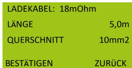
In diesem Menü ist die Länge und der Querschnitt des Ladekabels einzustellen. Mit dieser Einstellung wird der Spannungsverlust über die Ladeleitungslänge kompensiert.
