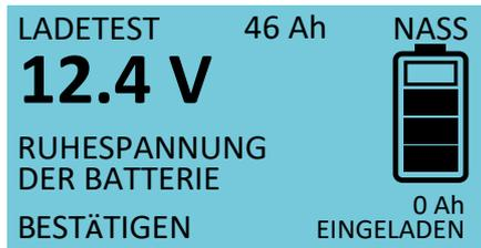
Nachdem die Batterie mit den Ladeklemmen verbunden ist zeigt das Ladegerät für 30 Sekunden die Klemmspannung der verbundenen Batterie als Zahl und Balkenanzeige im Batterie-Symbol an. Danach startet der Ladevorgang automatisch. Sie können die Anzeige der Batterieruhespannung mit der „BESTÄTIGEN“-Taste überspringen.
