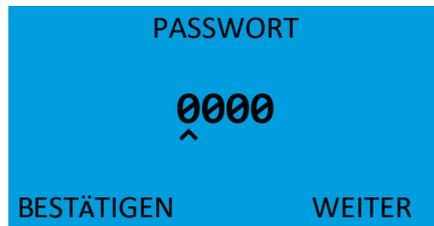
Um den „SCHAURAUM MODUS“ zu deaktivieren, drücken Sie die STOP-Taste. Es folgt eine Passwortabfrage. Geben Sie das Passwort: „4182“ ein. Wählen Sie hierzu mit den Pfeiltasten die entsprechenden Zahlen aus. Mit der Auswahltaste „WEITER“ können Sie die einzelnen Ziffern auswählen. Nach korrekter Eingabe des Passwortes, bestätigen Sie mit „BESTÄTIGEN“ Ihre Auswahl. Nun entfernen Sie in den Einstellungen den Haken bei „SCHAURAUM MODUS“ mit der Auswahltaste „BESTÄTIGEN“.
