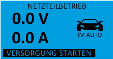
Wenn der maximale Stützstrom größer als 40 A ist, sinkt die Stützspannung proportional zur Belastung. Die Signalisierung einer Überbelastung wird in den unteren Punkten beschrieben.
