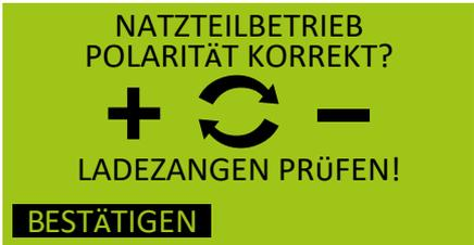
Aus Sicherheitsgründen wird die Polarität abgefragt. Der Bediener ist dazu angehalten, die Polarität an den Ladezangen zu überprüfen! Die Polaritätsprüfung muss mit der „BESTÄTIGEN“-Taste bestätigt werden.
