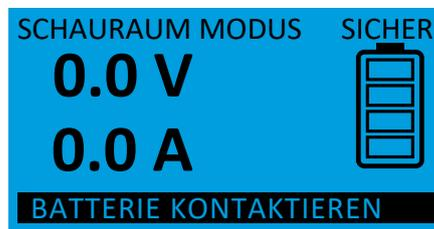
Mit der Auswahltaste „BESTÄTIGEN“ kann der „SCHAURAUM MODUS“ eingeschaltet (Haken erscheint im Display) oder ausgeschaltet (kein Haken im Display) werden. Wenn der „SCHAURAUM MODUS“ aktiviert ist (Haken gesetzt) gelangen Sie über „ZURÜCK“ in den abgesicherten Modus.
