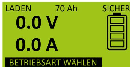
Falls keine Modusauswahl erfolgt, startet der Ladebetrieb automatisch mit der Einstellung SICHER und einer Batteriekapazität von 70 Ah, sobald die Klemmen an die Batterie angeschlossen sind.
