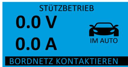
Akzeptieren Sie die Zusatzinformation über den Stützbetrieb durch drücken der „BESTÄTIGEN“-Taste. Das Gerät ist nun bereit.
