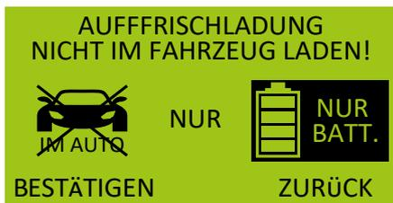
Im Auffrischungsmodus ist das Laden im Fahrzeug nicht erlaubt. Nur Einzelbatterie-Aufladung ist möglich, da die Ladespannung mehr als 16 Volt erreicht und die Bordelektronik beschädigen kann! Die Information „NICHT IM FAHRZEUG LADEN“ blinkt und Sie müssen dies mit der „BESTÄTIGEN“-Taste akzeptieren.
