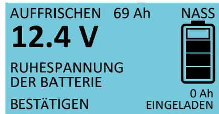
Nachdem die Batterie mit den Ladeklemmen verbunden ist zeigt das Ladegerät für 30 Sekunden die Klemmenspannung der verbundenen Batterie als Zahl und Balkenanzeige im Batterie-Symbol an. Danach startet der Ladevorgang automatisch. Sie können die Anzeige der Batterieruhspeisung mit der „BESTÄTIGEN“-Taste überspringen.
