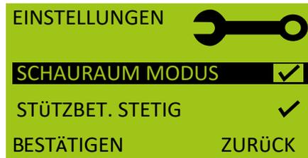
Der Schauraum-Modus dient dem Schutz des Gerätes vor Einstellungs-Änderungen durch nicht autorisierte Bediener. Das Ladeverhalten entspricht dem Laden im abgesicherten Modus.
