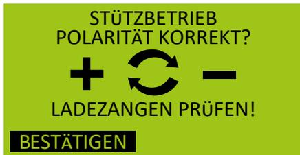
Bei einer Batterie mit einer Ruhespannung von unter 1,0 V wird aus Sicherheitsgründen die Polarität abgefragt. Der Bediener ist dazu angehalten, die Polarität an den Ladezangen zu überprüfen! Die Polaritätsprüfung muss mit der „BESTÄTIGEN“-Taste bestätigt werden.
