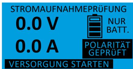
Bestätigen Sie die Polaritätskontrolle mit „VERSORGUNG STARTEN“. Das Ladegerät ist nun einsatzbereit.
