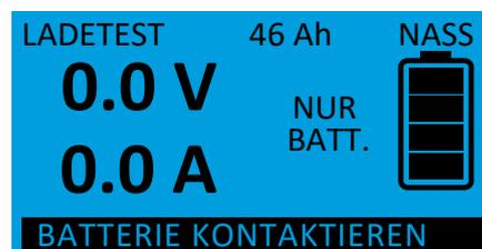
Wenn alle Einstellungen vorgenommen sind, ist das Gerät bereit, die ausgewählte Funktion zu starten, nachdem die Klemmen mit einer Batterie mit mind. 1,0 V Ruhespannung verbunden sind.
