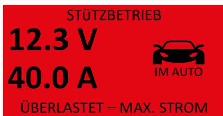
Nutzt das Bordnetz mehr als die maximalen 40 A, die das Ladegerät unterstützen kann, muss der zusätzliche Strom durch die Batterie abgedeckt werden und die Spannung sinkt proportional zur Belastung. Das Ladegerät warnt Sie mit einem rot leuchtenden Bildschirm und der Information „ÜBERLASTET – MAX. STROM“. Das Display blinkt alle 10 Sekunden und die Information „ÜBERLASTET – MAX. STROM“ blinkt im Sekundentakt.
