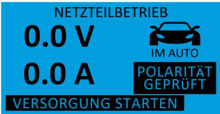
Wenn die Polaritätskontrolle bestätigt ist, ist das Ladegerät einsatzbereit, nachdem Sie die Taste „VERSORGUNG STARTEN“ gedrückt haben. Es befindet sich ein Spannung von 13,8 V an den Klemmen. Dieser Modus unterstützt ein Bordnetz ohne eingebaute Batterie oder eine elektrische Last mit konstant 13,8 V und max. 40 A.
