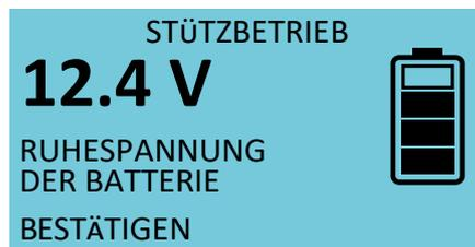
Nachdem die Batterie mit den Ladeklemmen verbunden ist zeigt das Ladegerät für 30 Sekunden die Klemmenspannung der verbundenen Batterie als Zahl und Balkenanzeige im Batterie-Symbol an. Danach startet der Ladevorgang automatisch. Sie können die Anzeige der Batterieruhe-spannung mit der „BESTÄTIGEN“-Taste überspringen.
