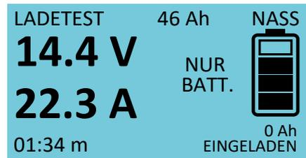
Bei der Stromaufnahmeprüfung wird über die Dauer von 5 Minuten die Stromaufnahmeprüfung der Batterie überprüft. Sie wird mit einem Strom von 30,0 A und einer maximalen Ladespannung von 14,4 V über 5 Minuten geladen. Danach erfolgt über eine weitere Minute bei abgeschaltetem Strom eine Überprüfung der Ruhespannungslage, um Zell- oder Plattenkurzschlüsse zu ermitteln. Nach insgesamt 6 Minuten ist die Prüfung beendet und das ermittelte Ergebnis wird im Display angezeigt.
