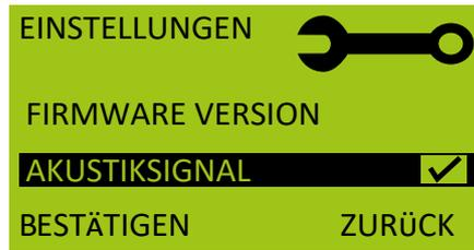
Mit der „BESTÄTIGEN“-Taste kann der Signalgeber eingeschaltet (Haken erscheint im Display) oder ausgeschaltet (kein Haken im Display) werden.
