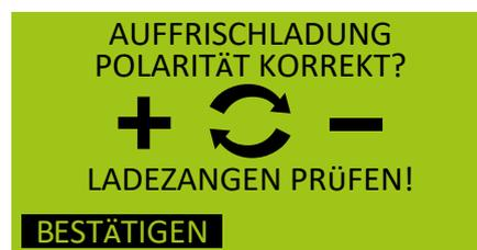
Bei einer Batterie mit einer Ruhspeisung von unter 1,0 V wird aus Sicherheitsgründen die Polarität abgefragt. Der Bediener ist dazu angehalten, die Polarität an den Ladetzangen zu überprüfen! Die Polaritätsprüfung muss mit der „BESTÄTIGEN“-Taste bestätigt werden.
