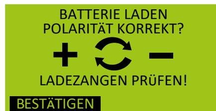
Bei einer Batterie mit einer Ruhspeisung von unter 1,0 V wird aus Sicherheitsgründen die Polarität abgefragt. Der Bediener ist dazu angehalten, die Polarität an den Ladezangen zu überprüfen! Die Polaritätsprüfung muss mit der „BESTÄTIGEN“-Taste bestätigt werden.
