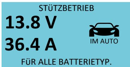
Dieser Betriebsmodus unterstützt ein Bordnetz mit eingebauter Batterie mit konstant 13,8 V und maximal 40 A. Die aktuellen Werte von Volt und Ampere werden angezeigt und alle 0,5 Sekunden aktualisiert.
