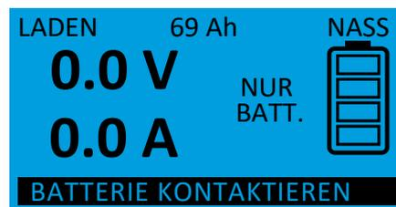
Alternativ kann der Ladestart einer tiefentladenen Batterie auch erzwungen werden, indem der linke Button unter der Aufforderung „Batterie kontaktieren“ für mind. 5 Sek. gedrückt gehalten wird. Damit gelangt man in den Bereich der Sicherheitsabfrage.
