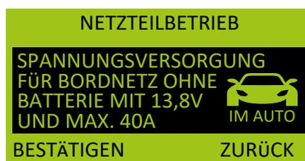
Der Netzteilbetrieb ist für Anwendungen ohne eine Batterie vorgesehen. Die Stützspannung von 13,8 V wird bis zu einen maximalen Stützstrom von 40 A geliefert.
