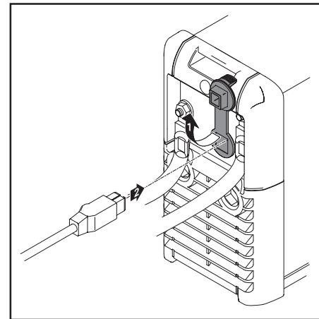
4. Ladegerät an das Netz anschließen
