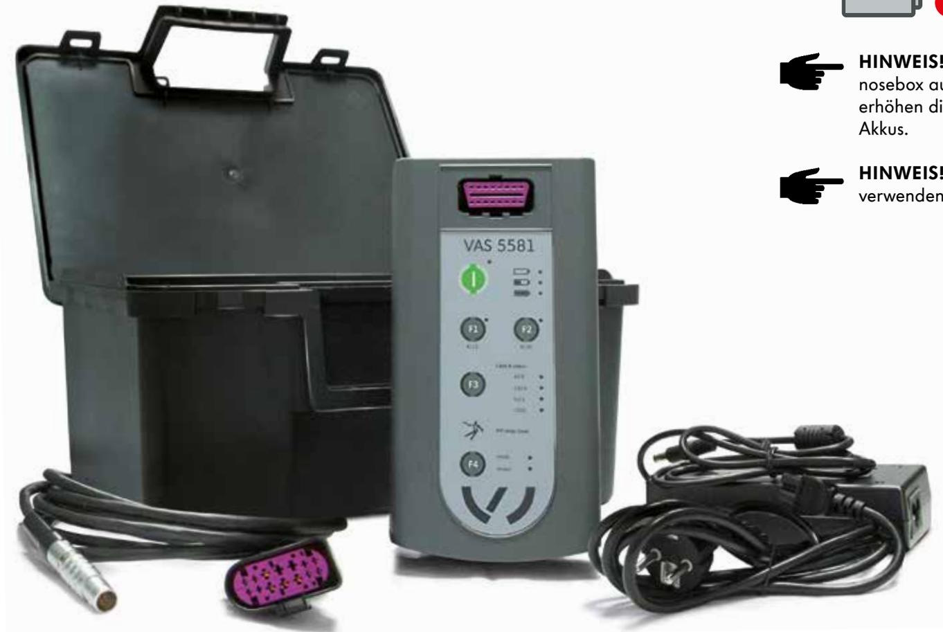
Ist das Netzteil an der Diagnosebox angeschlossen, befindet sich der Lademanager des internen Akkus in Ladebereitschaft. Das wird signalisiert durch Blinken der grünen LED mit dem Batteriesymbol „volle Batterie“ und geschieht unabhängig davon, ob ein Akku eingebaut ist oder nicht.
