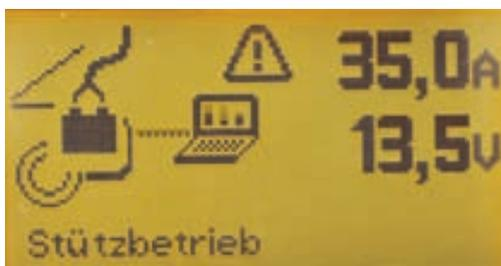
Stützbetrieb im Bordnetz mit verbauter Batterie bei Diagnose und eingeschalteten Verbrauchern bis maximal 13,5 Volt und 35 Ampere. Permanente Anzeige von Ladeverlauf, Betriebsart und elektrischen Werten.
