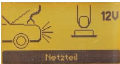
Netzteilfunktion für die Ersatzstromversorgung von Bordnetzen ohne verbaute Batterie oder ausgebauten Fahrzeugkomponenten zwecks Probelauf bei 13,5 Volt und maximal 35 Ampere. Manueller Programmstart mit Sicherheitsabfrage. Permanente Anzeige von Ladeverlauf, Betriebsart und elektrischen Werten.
