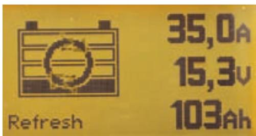
Auffrischladen von tiefentladenen Batterien außerhalb des Bordnetzes bis maximal 16 Volt und 35 Ampere. Vorwahl der Batterienennkapazität und der Bauart (Nass, AGM, Gel). Permanente Anzeige von Ladeverlauf, Betriebsart und elektrischen Werten.
