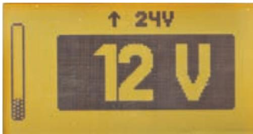
Leichte Menüführung dank übersichtlichem Display und automatische Erkennung der Bordspannung.
