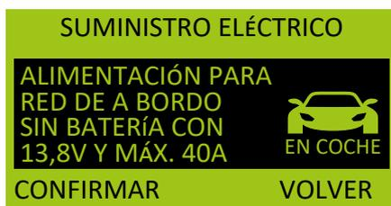
El modo de suministro eléctrico está destinado a aplicaciones sin batería. La tensión de apoyo de 13,8 V se suministra hasta una corriente de apoyo máxima de 40 A.
