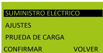
El modo de SUMINISTRO ELÉCTRICO hace posible el suministro eléctrico del vehículo durante trabajos de reparación con la batería desmontada o al efectuar un cambio de batería.
