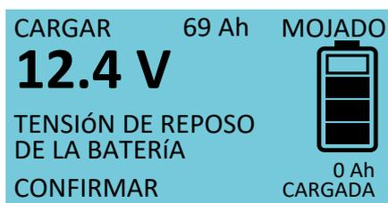
La tensión en reposo momentánea de la batería se indicará de nuevo durante 30 segundos. A continuación, el proceso de carga dará comienzo automáticamente.
