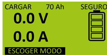
Si no se selecciona ningún modo de funcionamiento, nada más conectar los bornes a la batería la carga comenzará automáticamente en modo SEGURO a una capacidad de 70 Ah.
