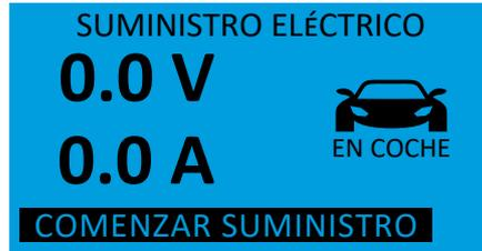
Si la corriente de apoyo máxima es superior a 40 A, la tensión de apoyo se reducirá de un modo proporcional a la intensidad. En los siguientes apartados se describe la señalización de una sobrecarga.
