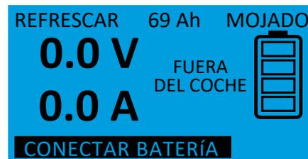
Una vez realizados todos los ajustes, el aparato estará listo para iniciar la función seleccionada al conectar los bornes a una batería con un mínimo de 1,0 V de tensión en reposo.
