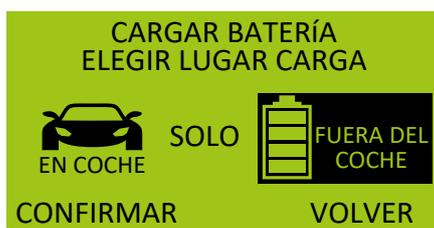
Seleccione el lugar de carga de la batería. Con las teclas de flecha, seleccione "EN COCHE" para cargar la batería en la red de a bordo del vehículo o "FUERA DEL COCHE" para cargar una batería individual fuera del vehículo. Confirme su selección con "CONFIRMAR".
