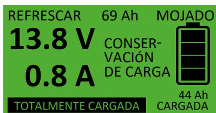
Una vez finalizado el proceso de carga de regeneración, comenzará automáticamente el proceso de conservación de carga con 13,8V. En este estado, las 4 barras de carga y el indicador "CONSERVACIÓN DE CARGA" parpadean.
