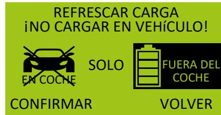
En el modo de regeneración no se permite la carga dentro del vehículo. En este modo solo es posible la carga de baterías individuales, ya que la corriente de carga alcanza más de 16 voltios y podría dañar la electrónica del vehículo. El mensaje "¡NO CARGAR EN VEHÍCULO!" parpadeará; para confirmar esta información, pulse "CONFIRMAR".
