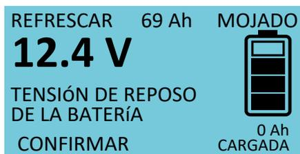
La tensión en reposo momentánea de la batería se indicará de nuevo durante 30 segundos. A continuación, el proceso de regeneración dará comienzo automáticamente.
