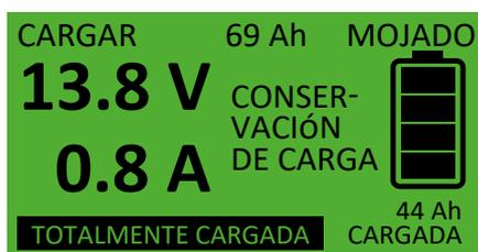
Una vez finalizado el proceso de carga normal, comenzará automáticamente el proceso de conservación de carga con 13,8 V. En este estado, las 4 barras de carga y el indicador "CONSERVACIÓN DE CARGA" parpadean.
