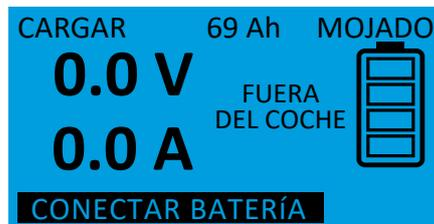
Como alternativa también se puede forzar el inicio de la recarga de una batería completamente descargada manteniendo pulsado durante 5 s el botón izquierdo con la solicitud "CONECTAR BATERÍA". De este modo se accede a la pregunta de seguridad.
