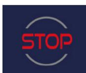
Pulse la tecla STOP. Desconecte la pinza de carga negra del polo negativo (-) de la batería y la pinza de carga roja del polo positivo (+).
