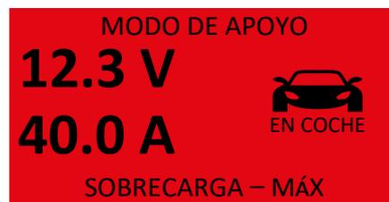
Si la red de a bordo utiliza una intensidad de corriente mayor de los 40 A proporcionados como máximo por el cargador, la corriente adicional deberá ser suministrada por la batería y la tensión se reducirá proporcionalmente a la intensidad. El cargador le avisará de ese hecho mostrando una pantalla de color rojo y el mensaje "SOBRECARGA – MÁX". La pantalla parpadea cada 10 segundos y el mensaje "SOBRECARGA – MÁX" cada segundo.
