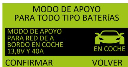
El modo de apoyo es apto para todos los tipos de baterías. La tensión de apoyo de 13,8 V se suministra hasta una corriente de apoyo máxima de 40 A. Si la corriente de apoyo máxima es superior a 40 A, la tensión de apoyo se reducirá de un modo proporcional a la intensidad.
