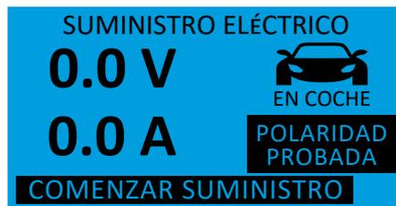
Una vez confirmado el control de polaridad, el cargador estará listo para el uso tras pulsar "COMENZAR SUMINISTRO". Los bornes tienen una tensión de 13,8 V.
