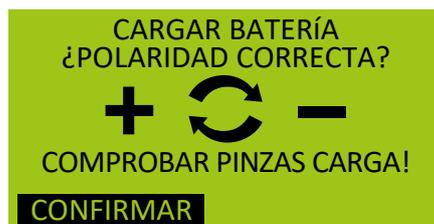
En baterías con una tensión en reposo inferior a 1,0 V, la polaridad existente se consulta por razones de seguridad. Se pide al usuario que compruebe la polaridad de las pinzas de carga. Tras efectuar dicha comprobación, confirme el proceso pulsando "CONFIRMAR".
