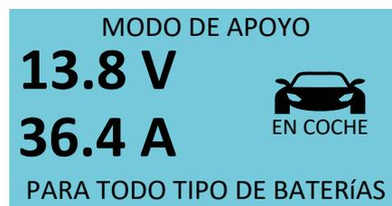
Este modo de funcionamiento alimenta una red de a bordo dotada de batería con una tensión constante de 13,8 V y una intensidad de corriente máxima de 40 A. Se muestran los voltios y amperios actuales, cuyas cifras se actualizan cada 0,5 segundos.
