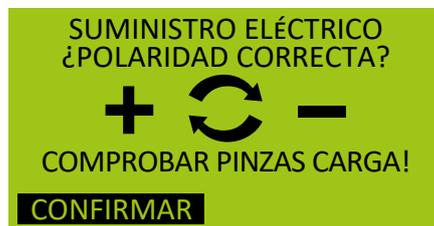
La polaridad existente se consulta por razones de seguridad. Se pide al usuario que compruebe la polaridad de las pinzas de carga. Tras efectuar dicha comprobación, confirme el proceso pulsando "CONFIRMAR".
