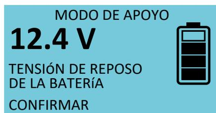
Una vez que la batería esté conectada con los bornes de carga, el cargador indicará durante 30 segundos la tensión de borne de la batería conectada en forma de valor numérico y como indicador de barras en el símbolo de la batería. A continuación, el proceso de carga dará comienzo automáticamente. Pulsando "CONFIRMAR" podrá detener la indicación de la tensión en reposo de la batería.
