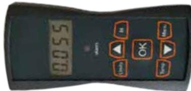
Leitfähigkeitsmessgerät mit Digital-
