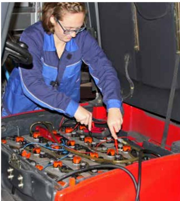
Für **Antriebsbatterien** bieten wir neben der jederzeit verfügbaren Instandsetzung von Verschleiß- und Gewaltschäden ein Wartungspaket mit Oberflächenreinigung gemäß Prüfungsverpflichtung der DGUV V3 an. Diesen Leistungsumfang erbringen unsere Monteure jährlich an mehr als 10.000 Antriebsbatterien. Oft genutzt wird die 12-monatige Mobilitätsgarantie. Profitieren Sie von unserem professionellen Know-how.
