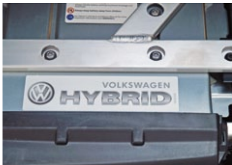
Die Hybrid-Batterie des VW Touareg
