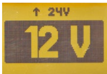
Automatische Erkennung der Bordspannung
